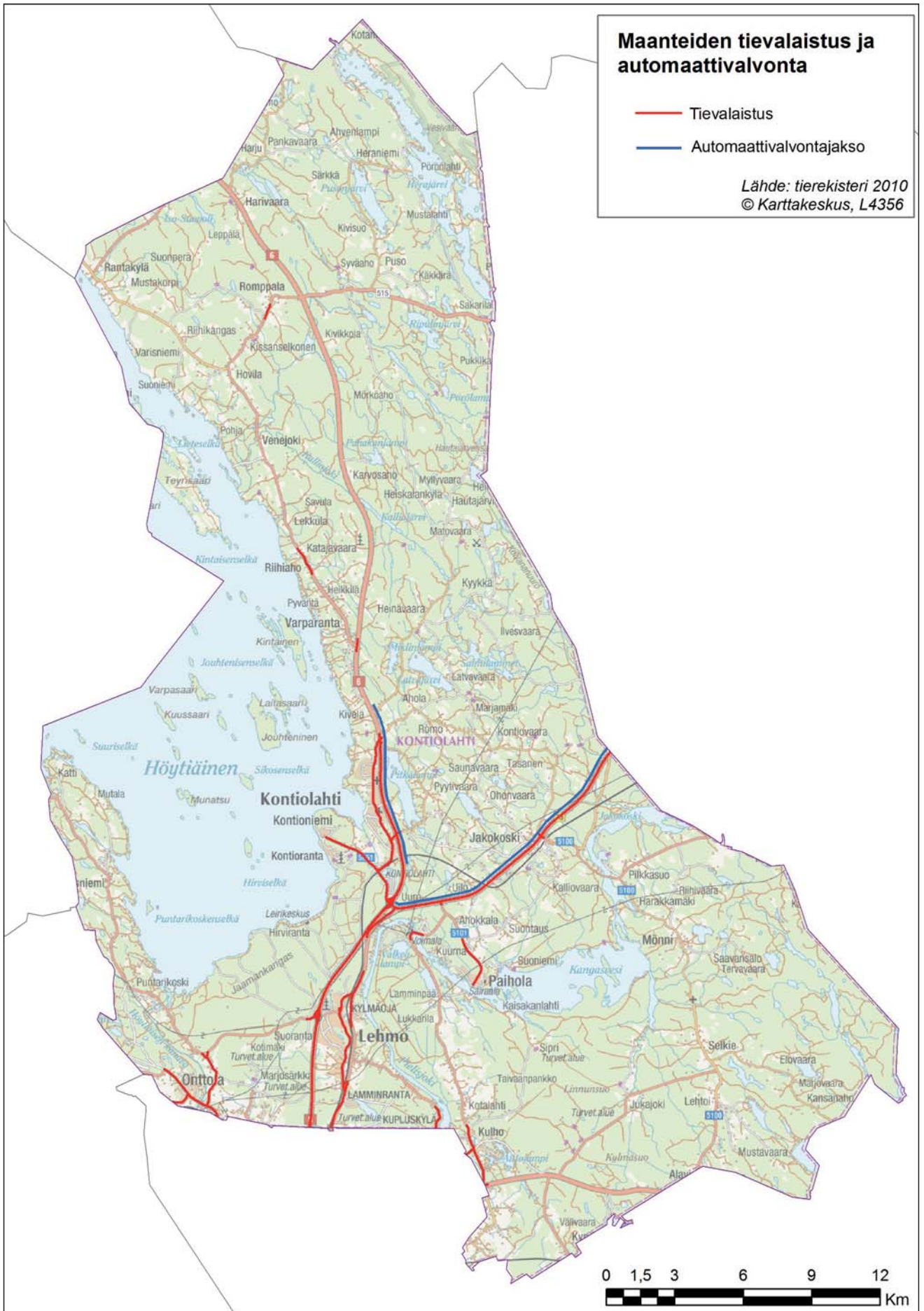
Kuva 4. Kontiolahtien maanteiden tievalaistus ja automaattivalvontajaksot.
